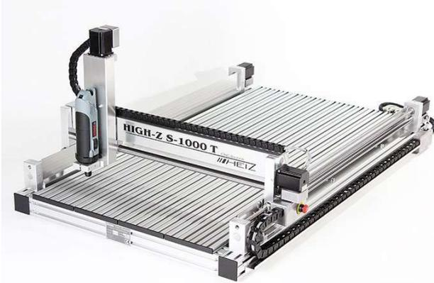
Avant d'être utilisée, la machine nécessite un programme, généralement créé dans un logiciel qui génère du code G. Il gère principalement des objets plats comme des planches, bien que des pièces plus complexes comme des pieds de chaise soient également possibles. Cependant, la sécurisation des pièces peut s'avérer un défi, car ces machines ne disposent généralement pas de systèmes de serrage ou d'aspiration intégrés.
