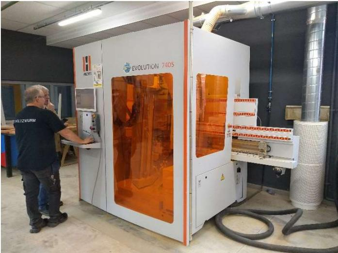
Le programme est créé avec le logiciel intégré WOODWOP (Homag) ou NC-HOPS (Holzher), qui est situé sur l'ordinateur local de la machine via des programmes dédiés qui peuvent créer des codes G pour le fonctionnement de la machine CNC.
